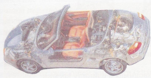
Двухместный Porsche Boxter имеет двигатель центрального расположения
