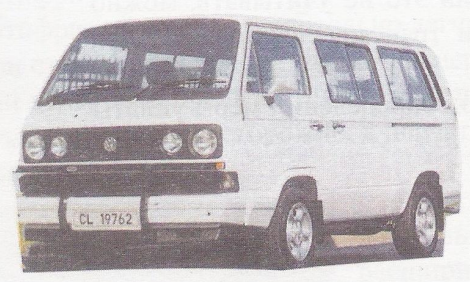
С кузовом типа комби VW T2 - до 9 сидящих мест легковой автомобиль (часто ошибочно называют микроавтобусом) имеет заднее расположение двигателя с горизонтально расположенными цилиндрами
